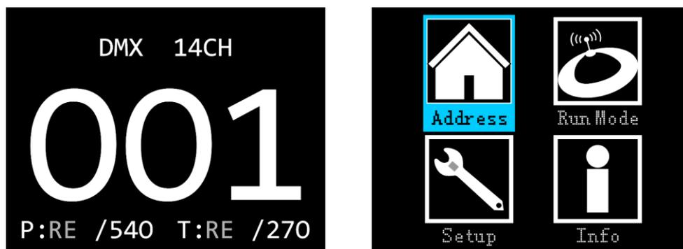
**Hinweis:** Wenn 30 Sekunden lang keine Taste betätigt wird, schaltet sich das Display aus. Drücken Sie eine beliebige Taste, um das Display wieder zu aktivieren.
